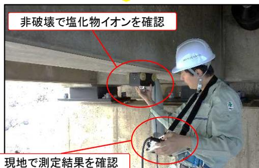
近赤外線分光法によるローラ付装置で面的かつ迅速に測定
