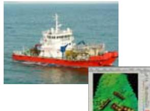
海中に船舶航行の障害となる沈下物がないか、マルチビーム音響測深機を搭載した九州地方整備局の環境整備船で海底の地形を調査します。
