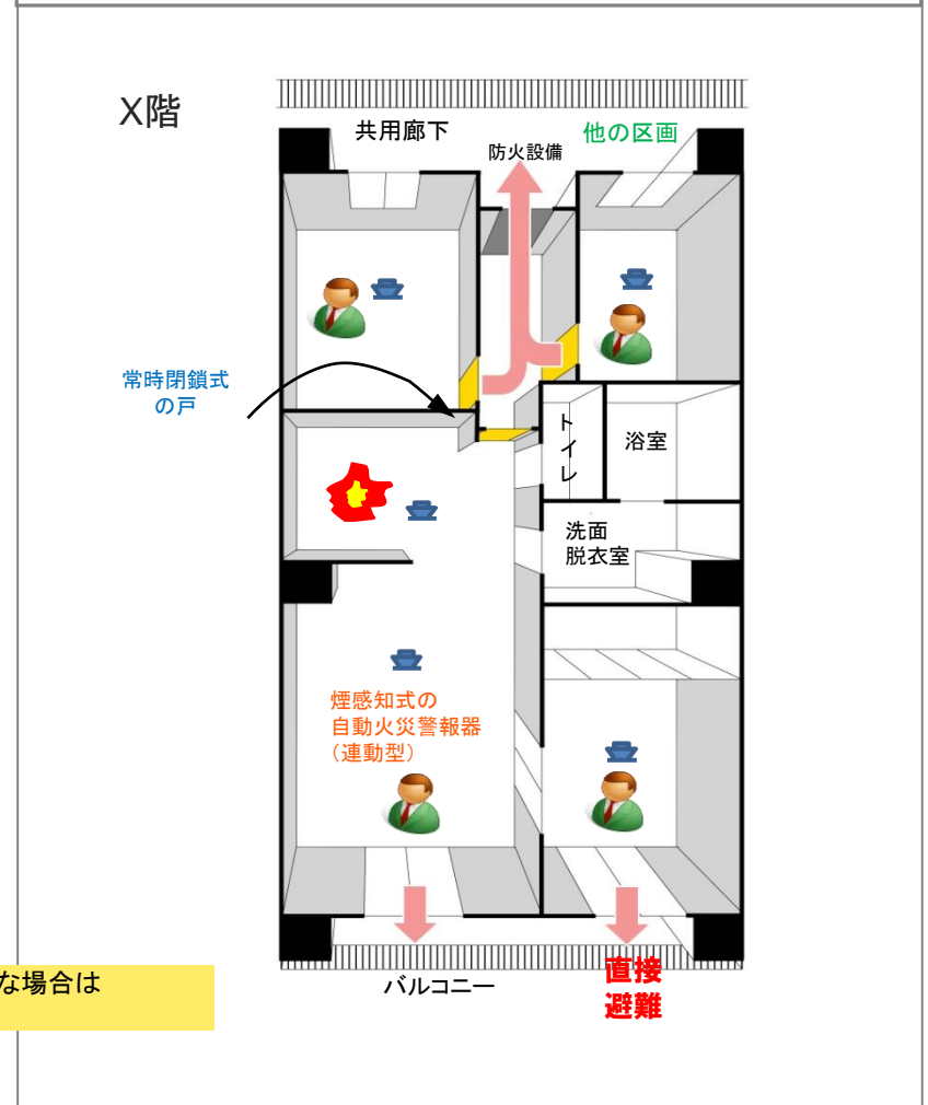
マンションの1住戸を寄宿舍に転用する場合を想定した例
