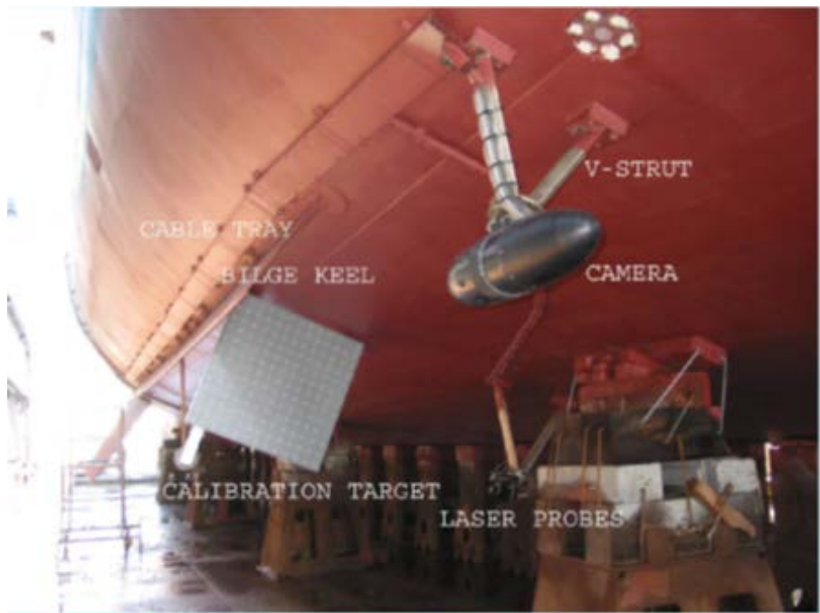
図 2 PIV 計測に用いられる較正板の例 5
