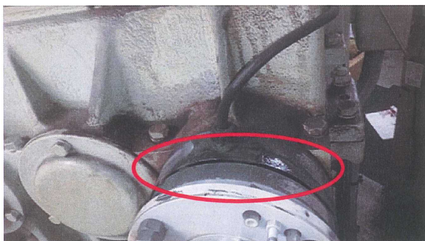
写真1 事故後のブレーキの状態（発熱痕）
