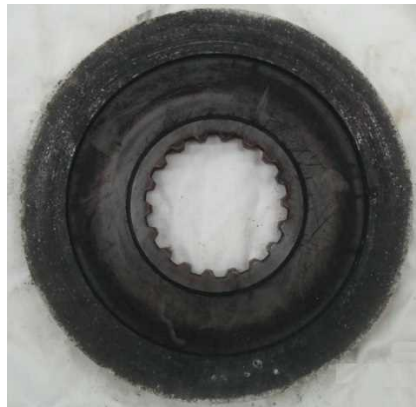
写真 13 ブレーキのパッド制動面 (事故機)
