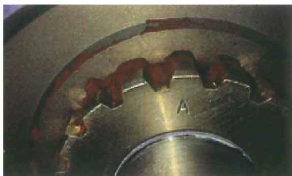
写真 1 0 スプライン部の摩耗粉（押付力－摩耗量試験）
