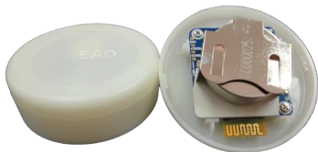
HRM5032（ホシデン製BLEビーコン） （昨年度設置したものと同型）
