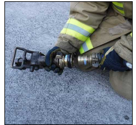
Step3 40mmホースへのマリンノズル取付
