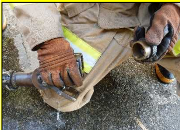
Step1 高速噴霧チップの取り外し
