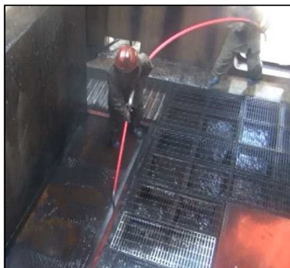
Step3 （中規模火災） アプリケーションノズルの水霧を下に向けてビルジ区画の冷却消火を実施する。
