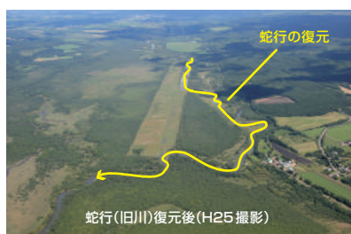
蛇行復元による湿原再生(釧路市)
