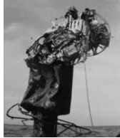
損傷した浮体式灯標
