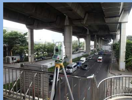
【高架橋でのデモンストレーション】 —100メートル離れた構造物の ひび割れも計測可能
