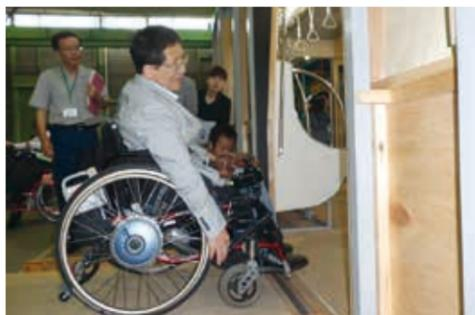
モックアップを使った隙間、段差の確認
