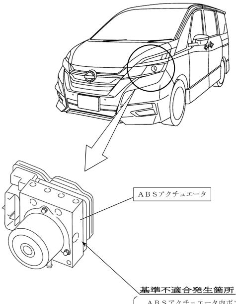
ABSアクチュエータ内ポンプにおいて、組付け 設備の調節が不適切なため、組み付け時にポンプ内 部のシールが破損したものがある。そのため、AB S作動時のブレーキ液の吐出圧が不足するおそれが あり、最悪の場合、ABS機能が作動せず、走行安 定性が損なわれるおそれがある。
