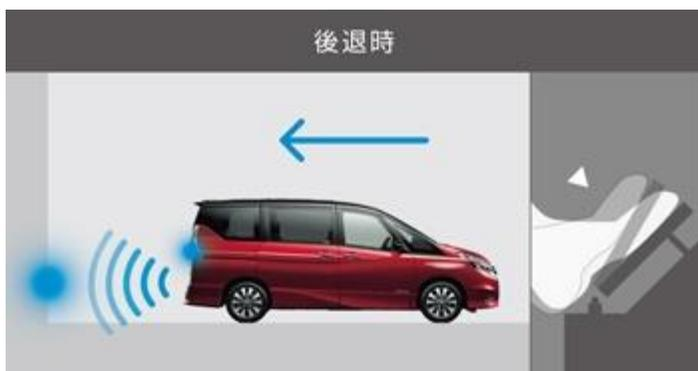
**低速加速抑制機能(前進時/後退時)**
