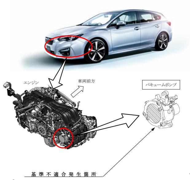
制動倍力装置のバキュームポンプにおいて、当該ポンプの製造が不適切なため、ポンプ内部に異物が残留しているものがある。そのため、異物により潤滑用油路が塞がれると、潤滑不良となりポンプ内部が破損し、負圧補助機能が失われ、高地等でブレーキを掛ける際、通常の踏力ではブレーキの効きが悪くなるおそれがある。また、ポンプ内部で破損した部品がエンジン内部に入り、エンジンが損傷するおそれがある。
