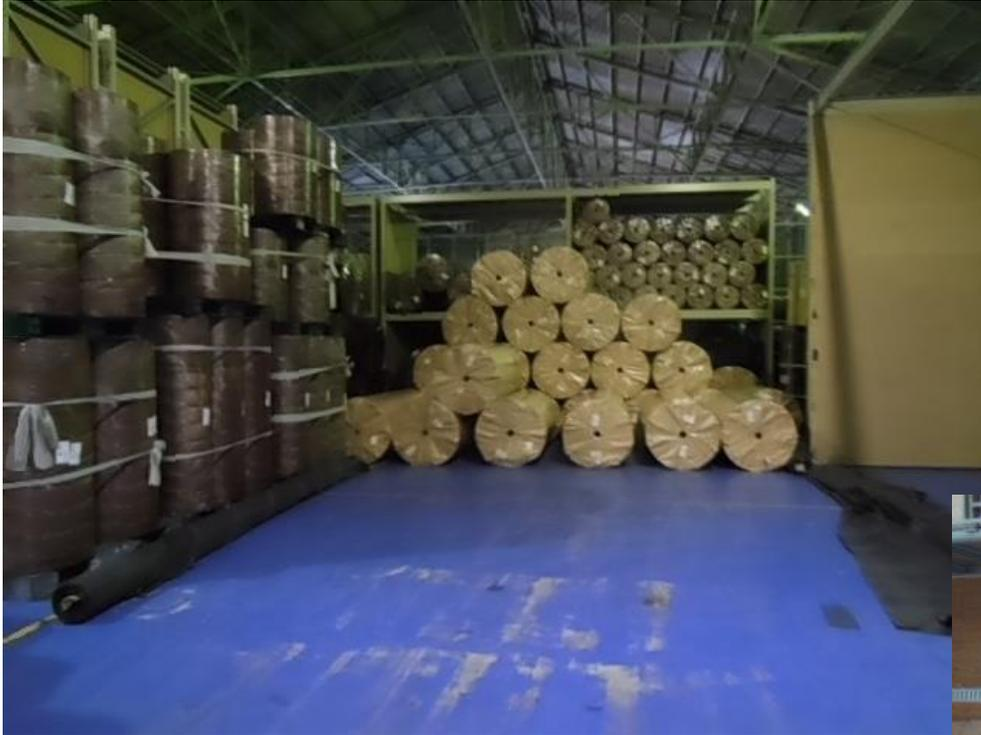
倉庫に横積みで保管されている製品は、1本ずつラムフォークリフトでトラック荷台に横積みで積みつけていく。
