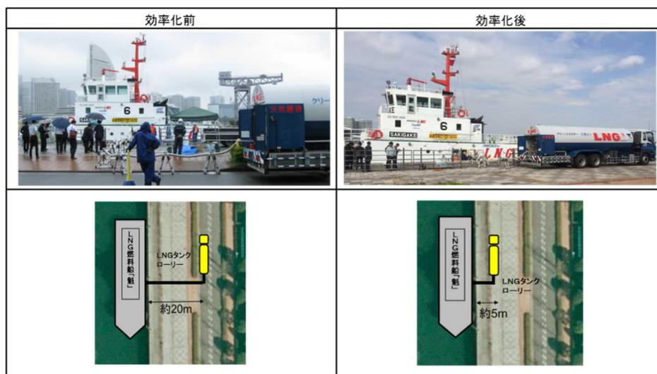
図 12.Truck to Ship バンカリングの効率化
