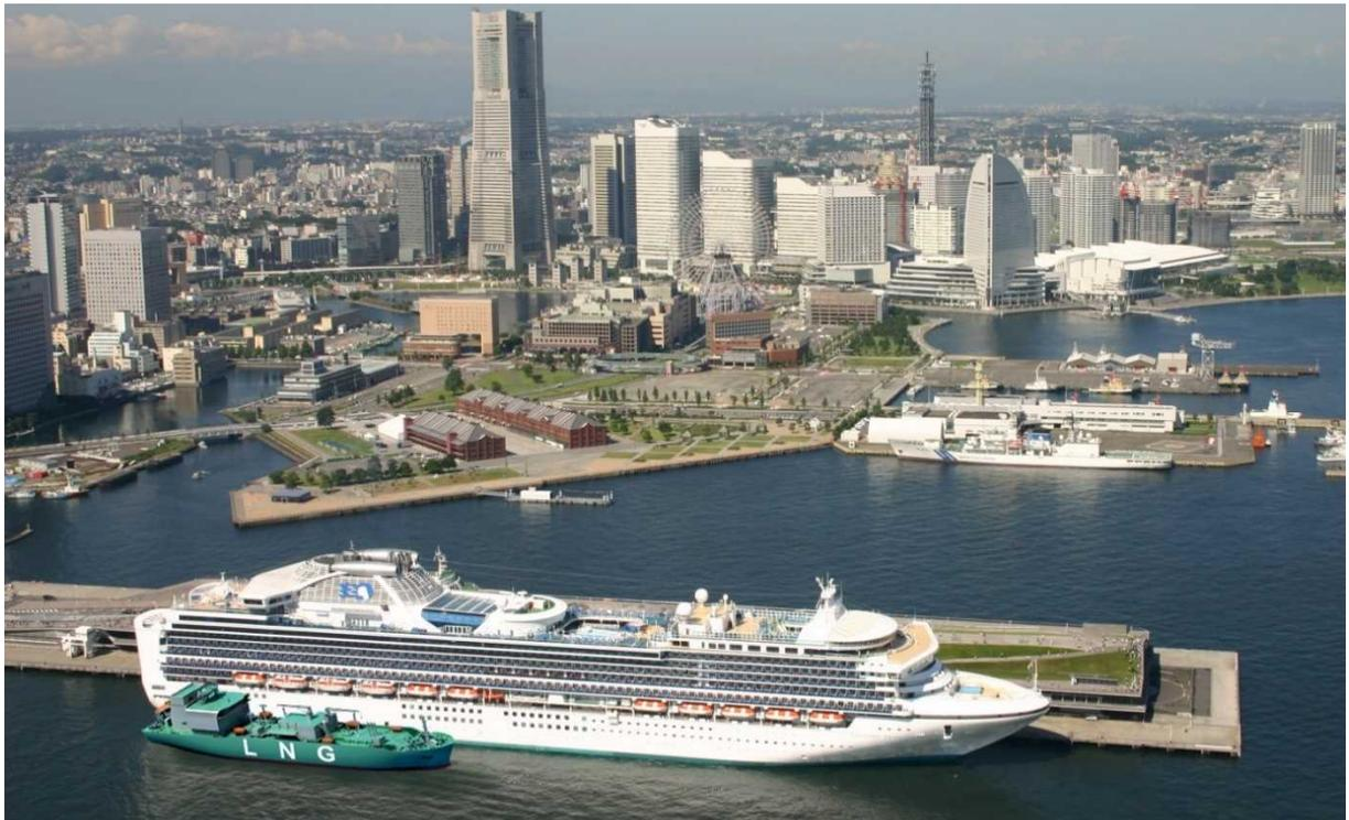
図 25. クルーズ船への「Ship to Ship」バンカリングイメージ図
