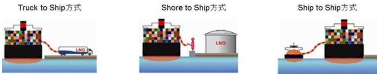
図6.バンカリングの手法
