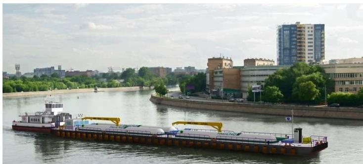
図 28. LNG燃料供給バージイメージ<sup>3</sup>
