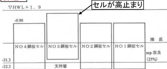
図3-7-2 鋼板セルの高止まり状況
