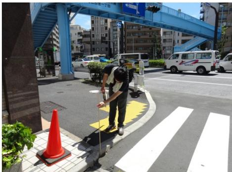
図 4-8. 定規や巻尺による計測イメージ
