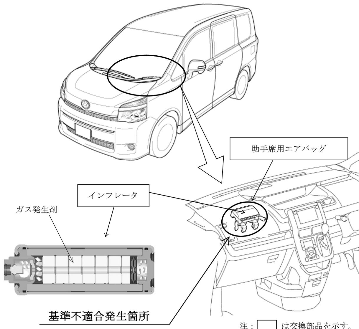
助手席用エアバッグのインフレーター（膨張装置）において、ガス発生剤の吸湿防止が不適切なため、温度および湿度変化の繰り返しによりガス発生剤が劣化することがある。このため、エアバッグ展開時にインフレーター容器が破損するおそれがある。
