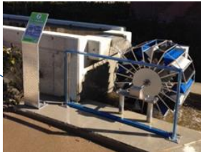
④水車発電機
