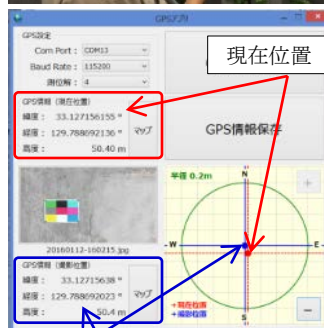
操作端末に表示させた点検ロボットカメラの位置情報
