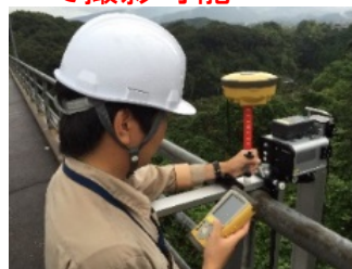
GPS機器と点検ロボットカメラの連動
