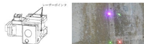
レーザーポインタ光を用いた方式
