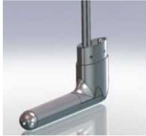
図 3 GARMIN 社 Air Data Probe
