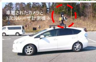
MMS(車両搭載型計測器)
