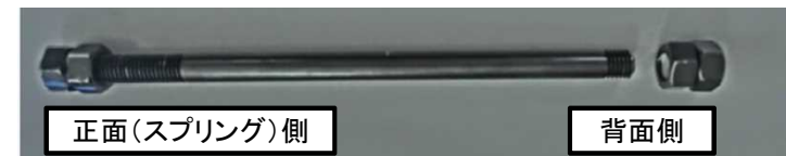
写真2 破断したスプリングシャフト
