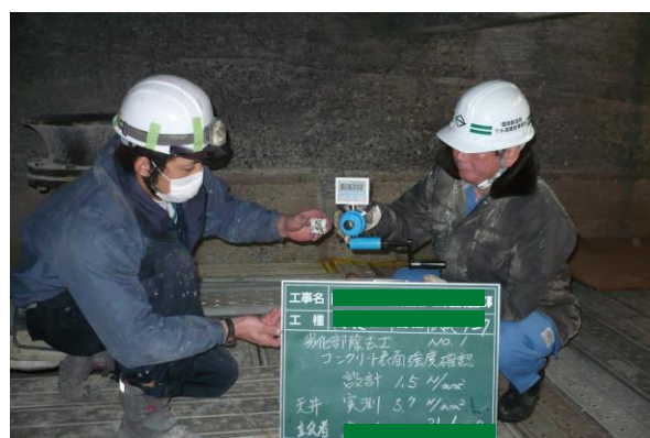
図 2-14 表面強度試験( 5.7\text{N/mm}^2 )
