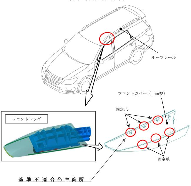
ルーフレールにおいて、フロントカバー取付け部の設定が不適切なため、ルーフレールを車体に組付ける際に、フロントカバーの固定爪の一部が損傷することがある。そのため、そのままの状態で使用を続けると、固定爪の損傷が拡大してガタが発生し、最悪の場合、走行中にフロントカバーが脱落し、他の交通の妨げになるおそれがある。
