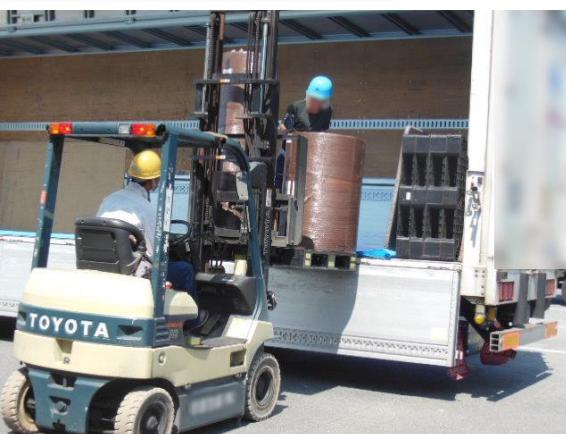
倉庫に横積み保管されている製品を、ラムフォークリフトで1本ずつトラックの荷台に積み付ける。
