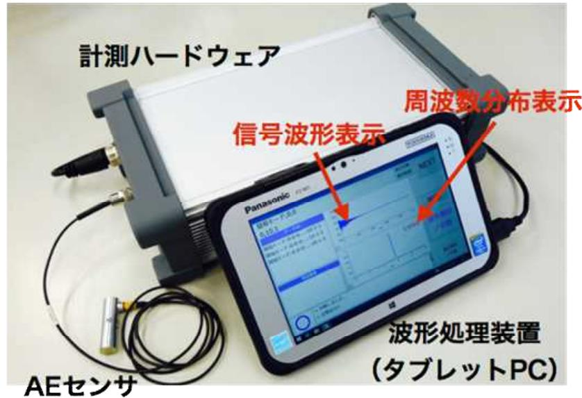
検査対象より得られる振動波形の周波数分布等により、施工不良、経年劣化等を検出。その場で簡易診断可能。
