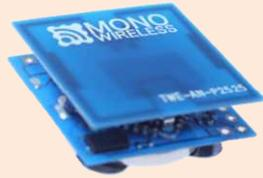
作業員や機械に装着。電波を定期的に発信。加速度センサー内蔵のため装着対象の動き検知も可。
