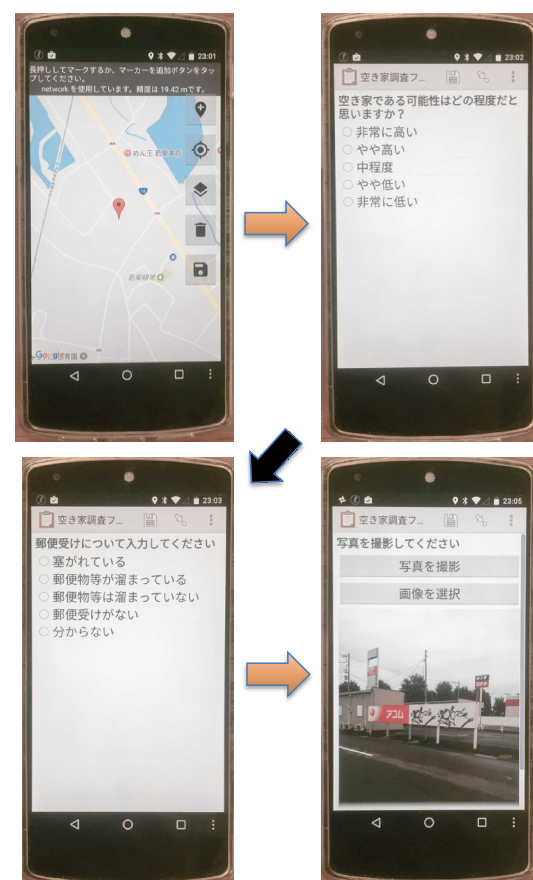
図3 入力フォームのプロトタイプをスマートフォンに表示した例。画面を指で触って右から左にスライドさせると次の入力項目が表示される。
