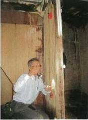
下げ振りによる柱の傾斜計測
