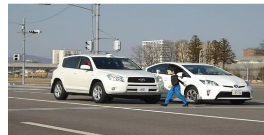
前方の歩行者を検知し、衝突による被害を軽減するために、運転者への警報及び制動装置の制御を行うシステム。
