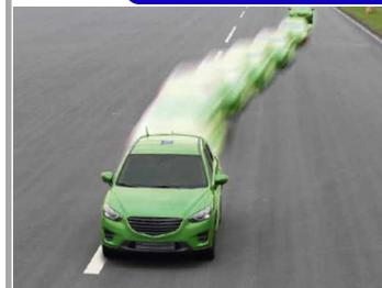
自動車が車線を逸脱する危険がある又は逸脱した場合に、操舵系や制動系などに自動介入することで車線を維持するように車両挙動を制御するシステム。
