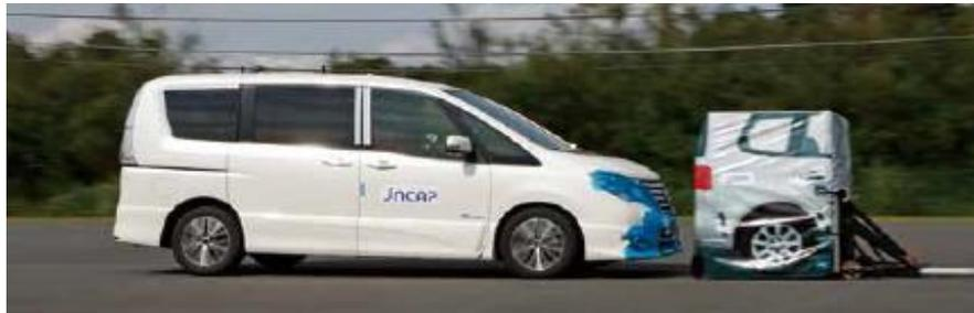
前方の障害物を検知し、衝突による被害を軽減するために、運転者への警報及び制動装置の制御を行うシステム。
