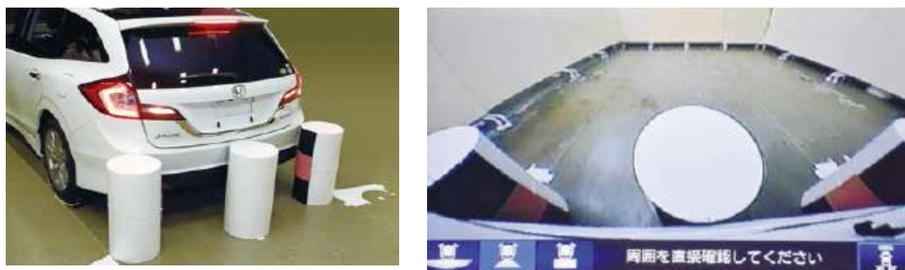
自動車の死角が生じるなどのために、事故の危険性が高まるバックでの発進、駐車時に、運転者が直接確認することが困難な後方の視界情報を車内のモニターに映し出すシステム
