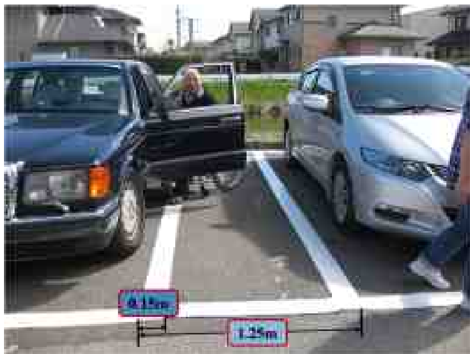
図一5 乗降幅を決めるための乗降実験
