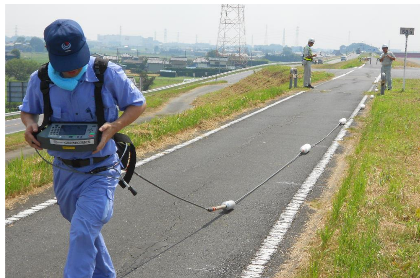
牽引式電気探査の実施状況
