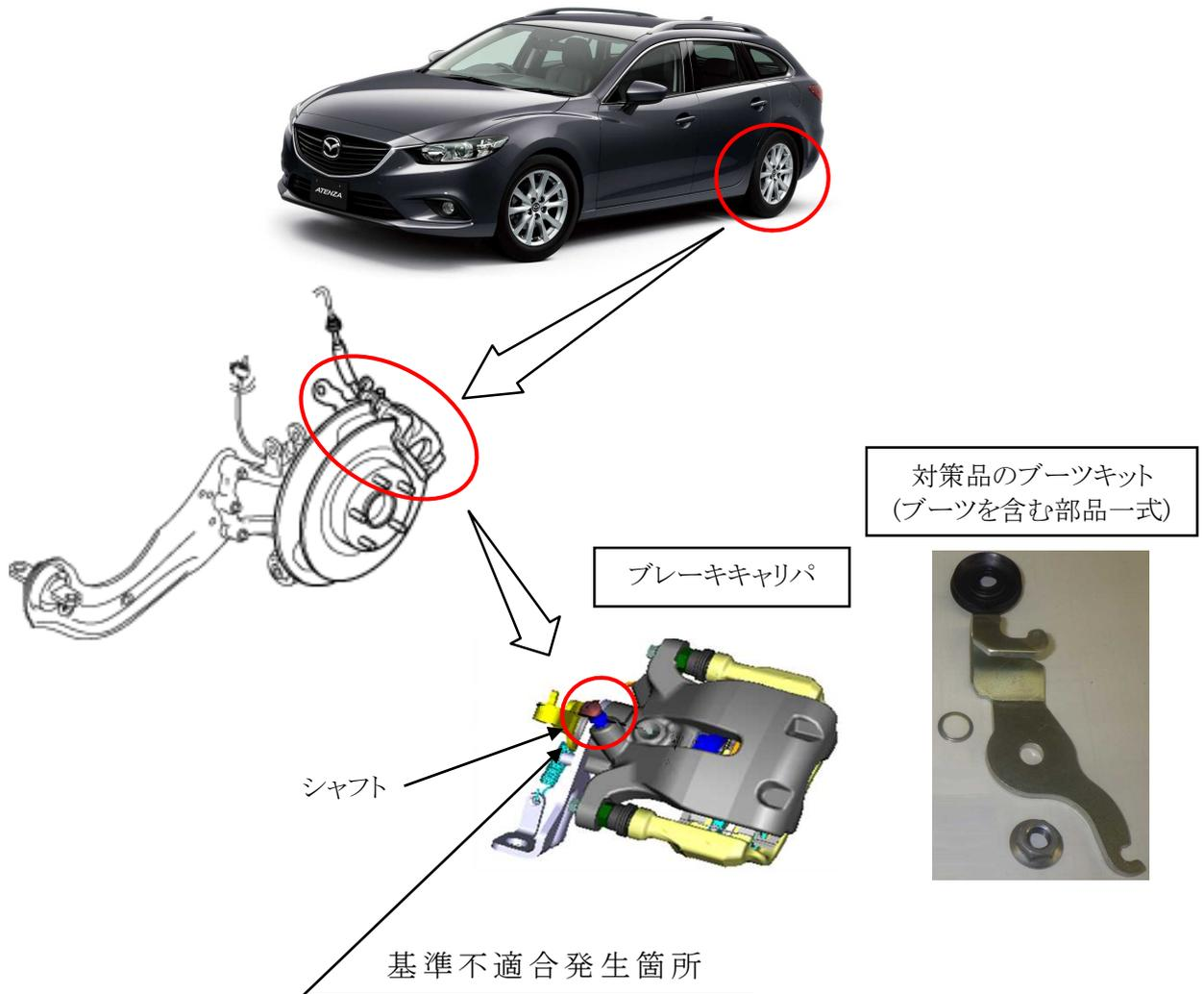
後輪のブレーキキャリパにおいて、ブーツのシール構造が不適切なため、キャリパ内部に水が浸入し、シャフトに錆が発生し腐食することがある。そのため、そのままの状態で使用を続けると、シャフトの摺動性が悪化し、駐車ブレーキの制動力が低下し、最悪の場合、車両が動き出すおそれがある。
