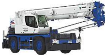
(ラフテレーンクレーン)
