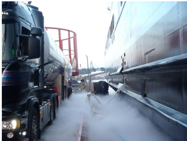
図 4.3 Truck to Ship 方式による LNG 燃料船供給 (例)
