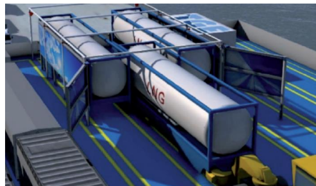
図 4.4 Portable Tank 方式による LNG 燃料船供給 (例 : Searoad Mersey II)
