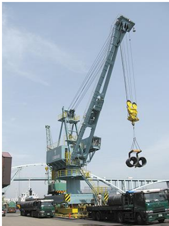
(ジブクレーン)
