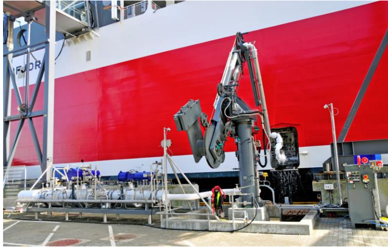
図 4.2 Shore to Ship 方式による LNG 燃料船供給 (例)
