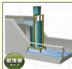
縦型斜流発電装置 (床置き式)
