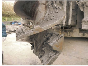
(d) 2回目掘進時（粘土層3m）
