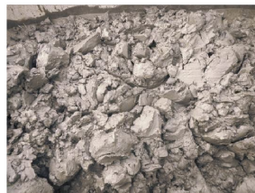
(f) 粘土層4.4m付近のハンマーグラブ掘削粘土
