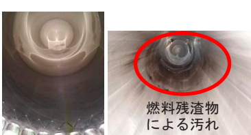
カメラによるシリンダ内部状態撮影 (左：新品、右：就航後)
