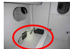
船底に設置したセンサー
