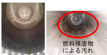
カメラによるシリンダ内部状態撮影 (左：新品、右：就航後)
