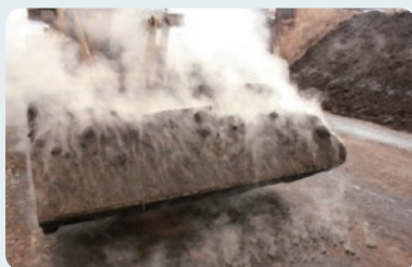
下水汚泥を高温発酵して肥料化
