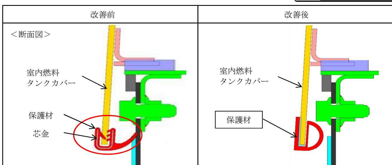
大型・中型路線バスにおいて、室内燃料タンクカバー端部の保護材の材質及び構造が不適切なため、乗客が乗降する際に手荷物等が接触すると、保護材の表皮が摩耗して内部の芯金が露出することがある。そのため、そのまま使用を続けると、乗客が露出した芯金の端部に触れて負傷するおそれがある。
