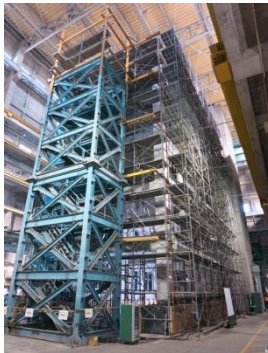
(a) 実大5層RC架構実験
