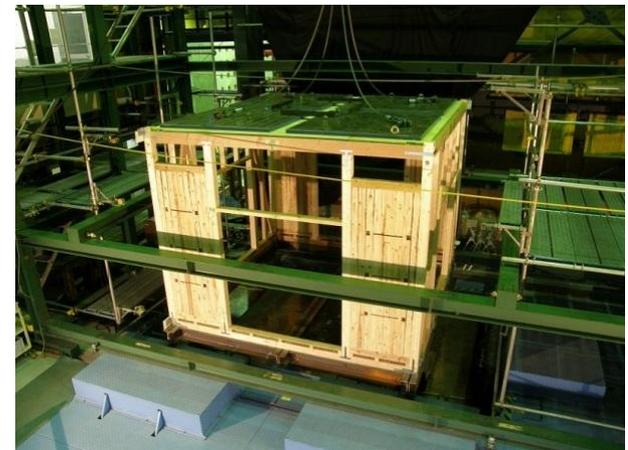
実物大振動台による動的耐震性能確認試験
