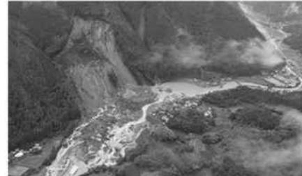
大規模な地すべりによる河道閉塞 (小野川)
