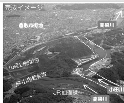
小田川合流点を下流に付け替えることにより、洪水時の水位を低下させ、倉敷市など流域の治水安全度の向上を図る。
