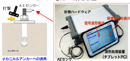
AEセンサーを用いた打音検査
