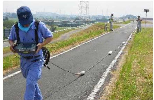
牽引式電気探査の実施状況
