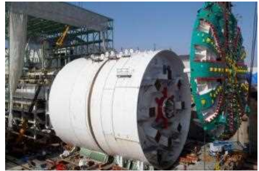
代替トンネル掘削に使用されたシールド機
