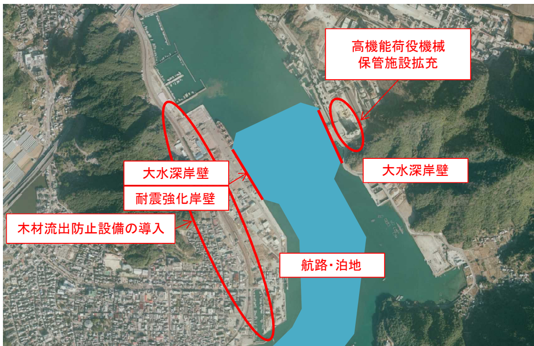
図 11 港町地区及び大峰地区の大水深岸壁の計画図（イメージ）
