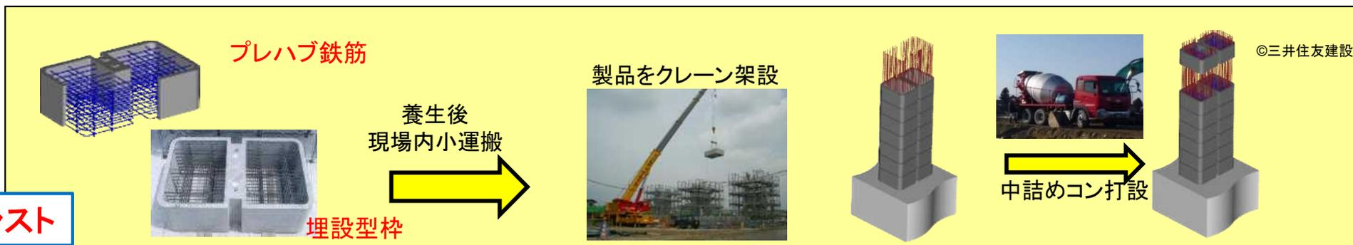
(例) 各部材の規格(サイズ)を標準化し、定型部材を組み合わせて施工
