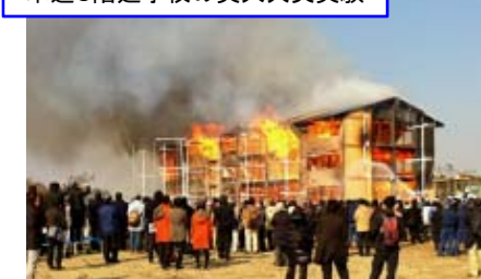
木造3階建学校の実大火災実験
